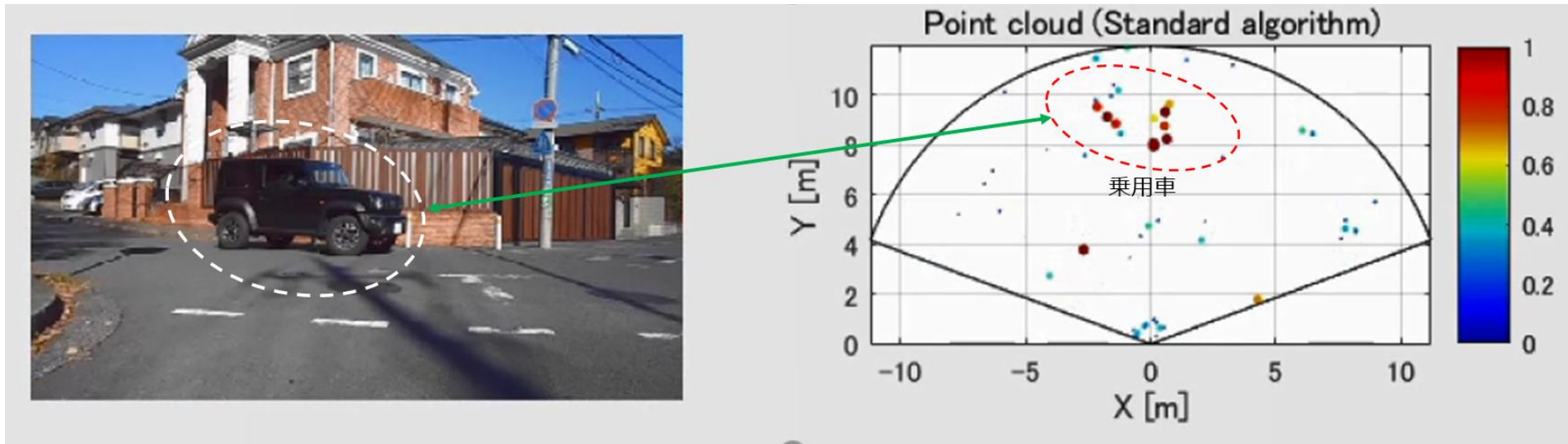
実車レーダ検知結果(神奈川工科大学 研究結果引用)
