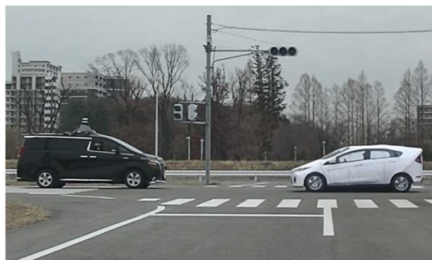
自動車ダミー(GST)を使ったAEB実験
