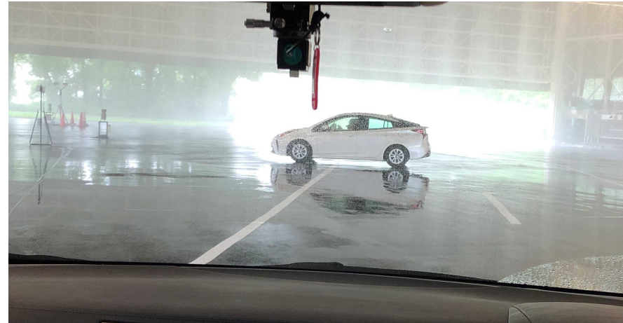
LiDAR(路面が鏡のようになり反射)
