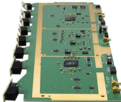
8個のRFフロントエンドを搭載した回路基板
